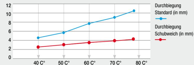
Im Sommer und Winter kommt es zu extremen Temperaturunterschieden zwischen innen und außen. Um ein damit verbundenes verbiegen des Türflügel zu minimieren haben unsere Türen einen „verzugsheftenden Flügel“. Dieser reduziert den Verzug auf ein Minimum und sorgt somit für eine optimale Dichtigkeit das ganze Jahr über.
