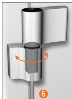
Lagerbuchse um  $\pm 90^\circ$  drehen bis sie spürbar einrastet (Dichtungsandruck  $\pm 0,5$  mm)
