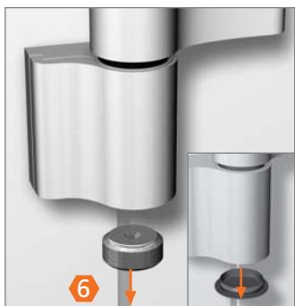
Untere Kappe entfernen. Nur am zu verstellenden Band Hebespindel herausschrauben. Bandweise vorgehen.
