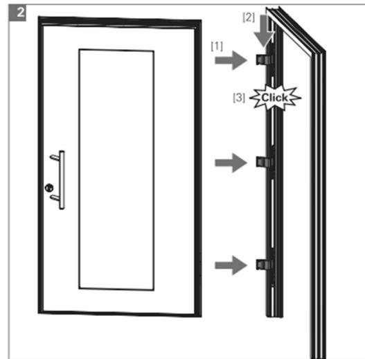
**INFO:** Türstopper oder Drehbegrenzer verwenden, sonst Kollision zwischen Flügel und Rahmen (Öffnungswinkel profilabhängig)
