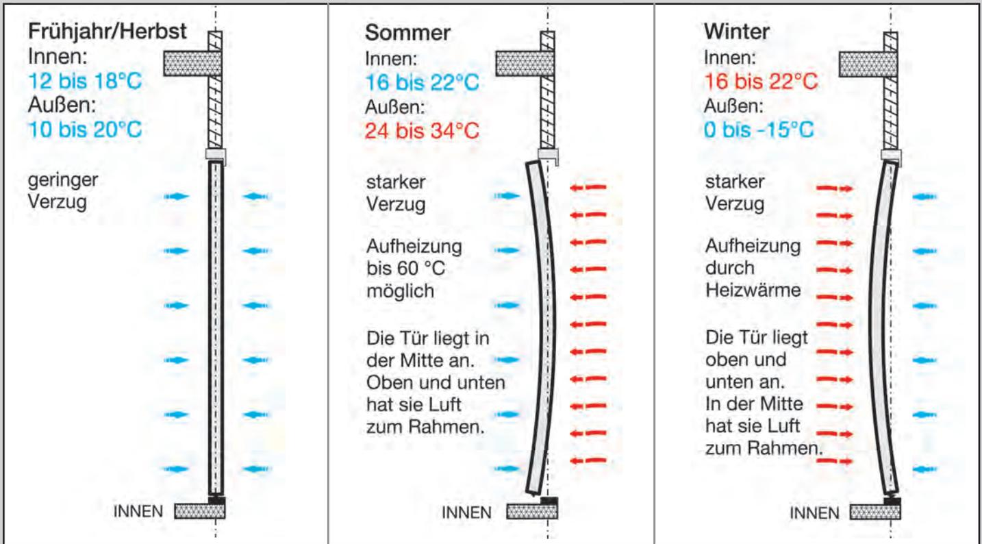
Bi-Metalleffekt: Durchbiegung des Türflügel bedingt durch hohe Temperaturunterschiede.
